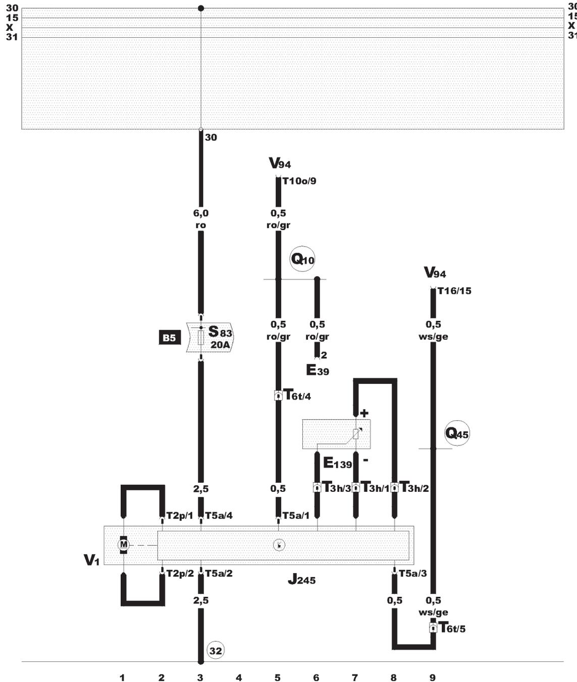
**Elektrisches Schiebedach mit Vorwählautomatik und Komfortschließung**
